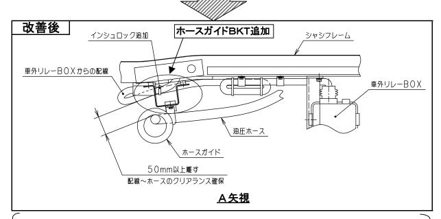
高所作業車の架装において、シャシの車外リレーボックスを移設した際に、当該リレーボックスの 配線と架装物の油圧ホースが干渉しているものがある。
