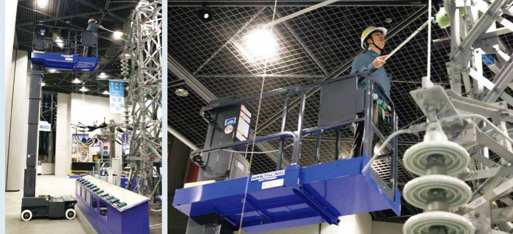
スライド式拡張デッキによって作業範囲が拡大。無理のない高所作業が可能に。「背の高い展示もありますから、高所作業車は欠かせません」と長谷川さま。
