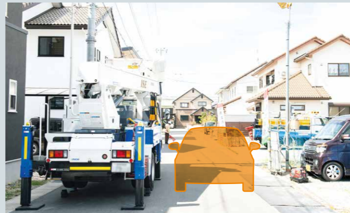
設置占有幅がコンパクトになったことで、一車線以上の道路幅確保が可能に。
