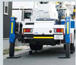
ジャッキストロークが65mm伸張したことで、傾斜地の車体の安定性を確保
