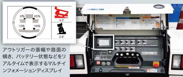
狭い場所での高所作業を実現する無段階アウトリガー
