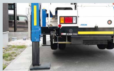
狭い場所での高所作業を実現する無段階アウトリガー
