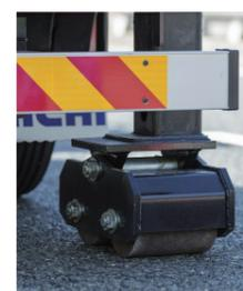
左右後方ジャッキにダブルローラーを採用し、接地圧を分散
