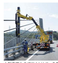
中型車両なのでアウトリガーを最大限に張り出しても、規制をかけた走行車線内にはまだ余裕がある
