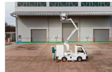
EV高所作業車
