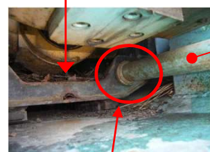
伸ワイヤ端部の錆点検(パイプ内を含む) 図2 ブーム後端内部
